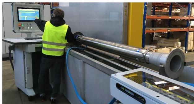
Auf dem Prüfstand kann die Direkteinschaltung gewählt werden, aber auch die Stern-Dreieckschaltung, für reduzierte Anlaufströme großer Pumpen. Ebenso ist der Betrieb mit Frequenzumrichter möglich, auf deren Ausgangsseite Sinusfilter sitzen, sogenannte Ausgangsdrosseln. Diese dämpfen den getakteten Ausgang der Frequenzumrichter, reduzieren die Flankensteilheit und schonen damit Motorwicklung und Kabel. Die Prüfleistung deckt den kompletten Lieferumfang an Pumpengrößen der GWE ab.
